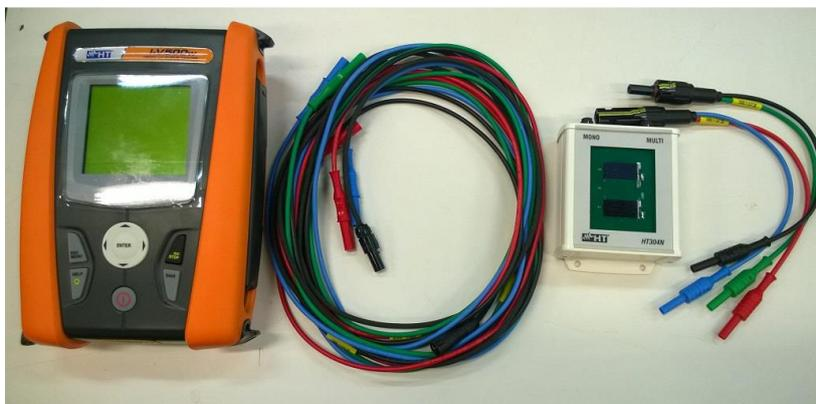
Figura 3 - Traçador de Curva IxV utilizado - modelo HT I-V500W
