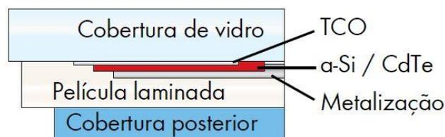
Fig. 1. Estrutura superstrato de módulos fotovoltaico de filme fino. (SMA, 2012)
