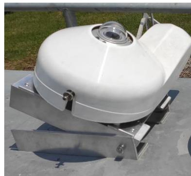
Fig. 4 Piranômetro CMP10: localizado na estação SONDA.
