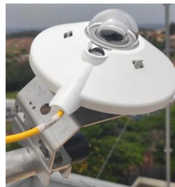
Fig. 5 Piranômetro CMP6: localizado na estação EPE.
