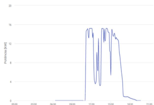
Figura 8 - Curva de geração do Sistema 2 no dia após a segunda troca de disjuntor
