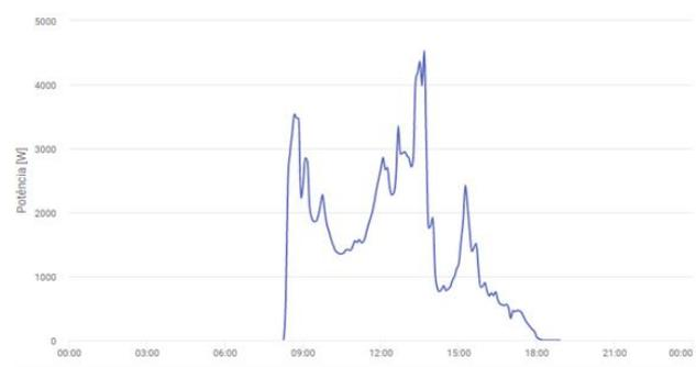
Figura 4 - Curva de geração do Sistema 1 no dia após troca de disjuntor
