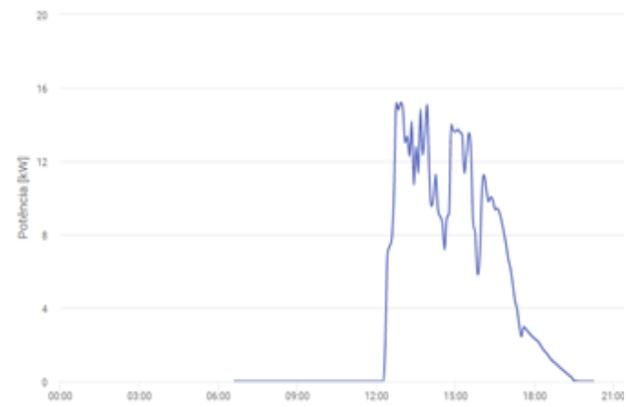
Figura 6 - Curva de geração do Sistema 2 no dia após a primeira troca de disjuntor
