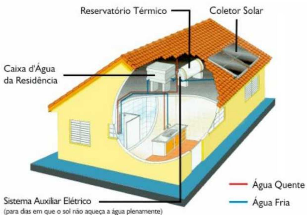
**Figura 15 – Esquema de funcionamento de um sistema de aquecimento solar**
