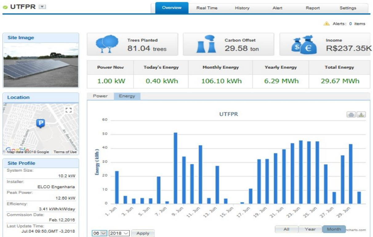
**Figura 38 – Energia Produzida em junho/2018, Sistema NEOVILLE (Monitor. Chintpower - Software da Web para armazenamento e análise dos parâmetros do inversor)**
