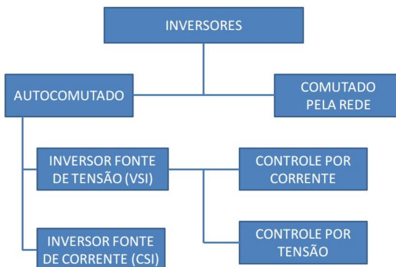
Figura 8 - Topologia dos inversores comutados e autocomutados
