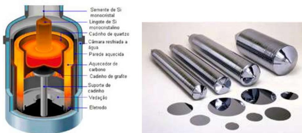
**Figura 3: Processo de fabricação Czochralski e lingotes monocristalinos**
