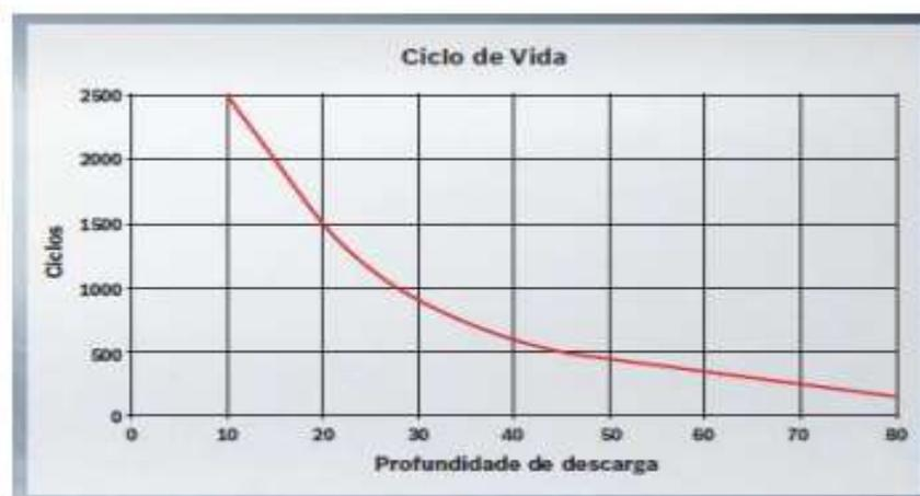
**Figura 8: Ciclos x Profundidade de descarga**
