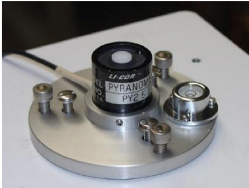
**Figura 6 - Piranômetro fotovoltaico**
