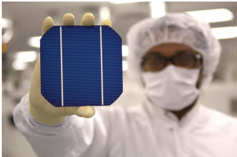
**Figura 15- Célula de silício monocristalino**
