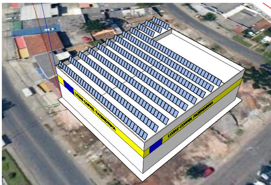
**Figura 31 - Módulos instalados inclinados no sentido vertical**
