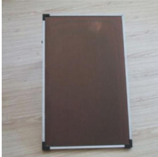
**Figura 17- Exemplo de painel solar de a-Si**
