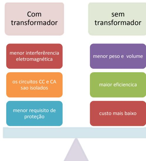
Figura 34 - Comparativo de inversor com e sem transformador de acoplamento
