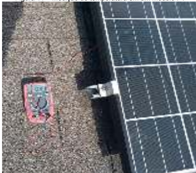
Figura 11 – Medição de temperatura em um módulo FV
