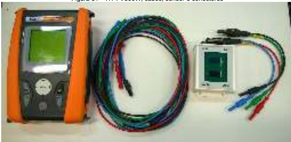
Figura 31 – HT I-V500W, cabos, sensor e conectores
