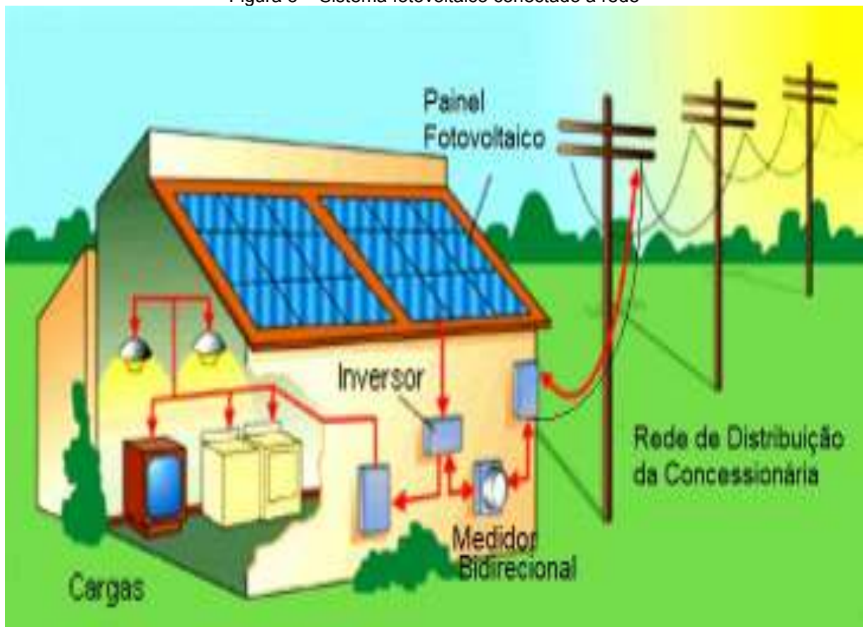
Figura 5 – Sistema fotovoltaico conectado à rede
