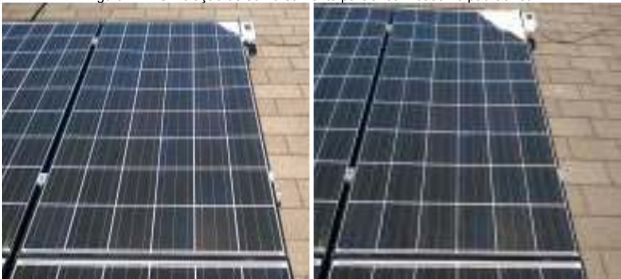
Figura 44 – Simulação de sombreamento parcial com base no padrão real
