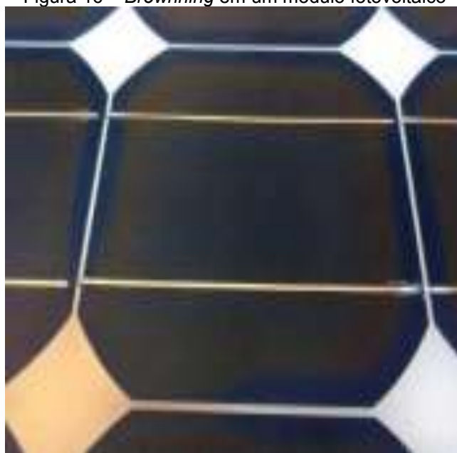
Figura 16 – Browning em um módulo fotovoltaico
