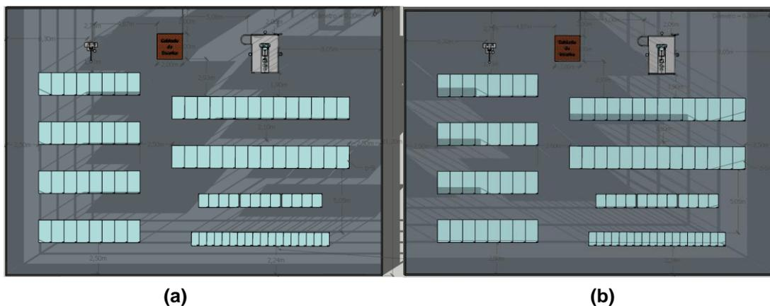
**Figura 1.** Análise de sombreamento da instalação dia 21/06/2019 (a)08h00min e (b) 17h00min.
