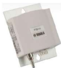
Figura 10. Barômetro da marca Campbell Scientific , modelo PTB110 Vaisala
