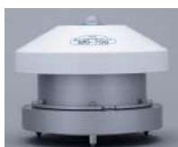
Figura 3. Espectroradiômetro da marca EKO, modelo MS-700N
