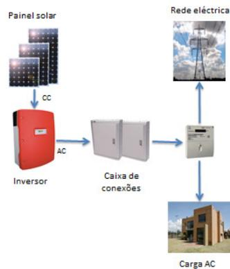
Figura 1 - Configuração de um SFVCR
